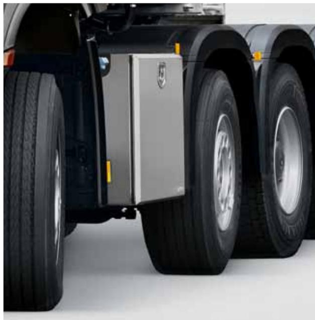
**Caixa de arrumação aço inoxidável<sup>1)</sup>.** A caixa de arrumação oferece um espaço de arrumação fora da cabina para ferramentas, assim como para material para fixação da carga. Esta pode ser carregada até 200 kg<sup>3)</sup>.
