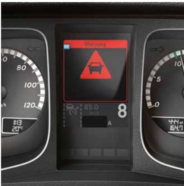
**Active Brake Assist 4<sup>2) 7) 9) 10)</sup>.** A quarta geração do sistema apoia o condutor<sup>7) 11)</sup>, na medida em que pode efetuar uma travagem a fundo perante objetos imóveis e em movimento e uma travagem parcial perante peões que se desloquem, podendo mitigar ou evitar na totalidade um acidente.
