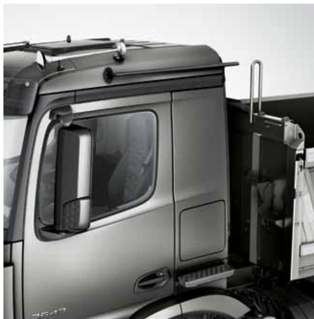
**Corrimão no tejadilho<sup>3</sup>.** Torna a inspeção da caixa mais confortável e segura. O degrau, integrado na parede lateral ou montado na parede traseira conforme a variante de cabina, permite uma posição segura.
