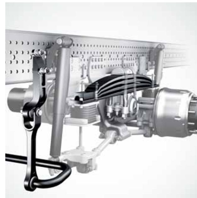
**Estabilizadores do eixo traseiro reforçados.** Para obter uma resistência extrema, os veículos Arocs Grounder como, por exemplo, o camião basculante de tração integral 8x8/4 podem ser equipados com estabilizadores reforçados<sup>1)</sup> no 2.º eixo traseiro.
