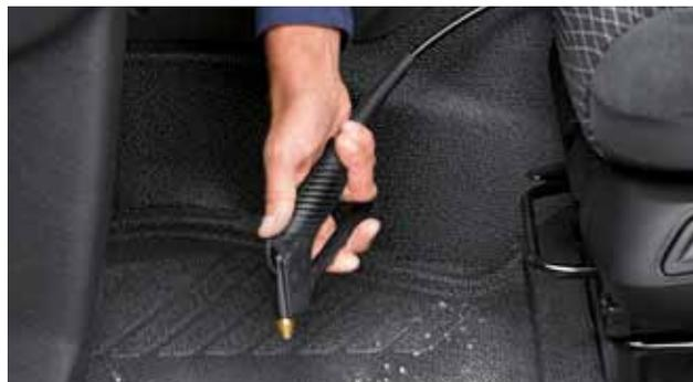
**Pistola de ar comprimido.** A pistola de ar comprimido com tubo em espiral presta um serviço muito útil na limpeza da cabina<sup>4)</sup>.
