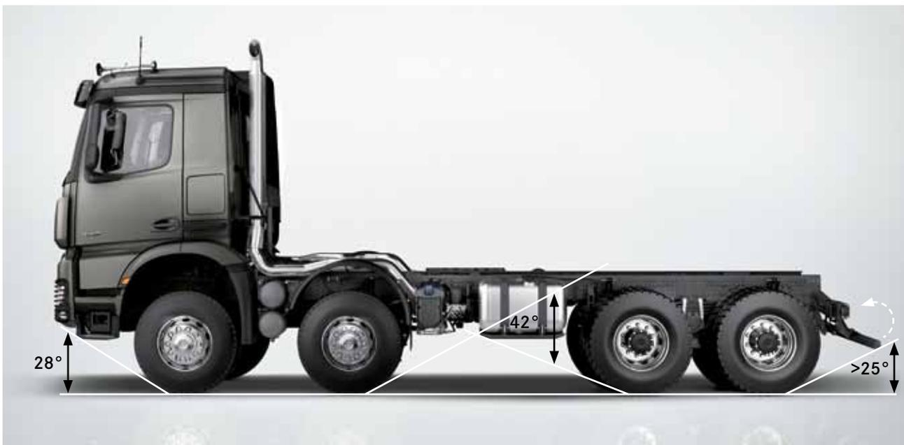
**Distância ao solo veículo basculante de tração integral.** Grande distância ao solo, os melhores ângulos de ataque, saída e ventral possíveis – os camiões basculantes de tração integral Arocs mostram as suas forças principalmente fora de estradas e caminhos alcatroados, nos lugares que exigem capacidades de todo-o-terreno sem qualquer compromisso.
