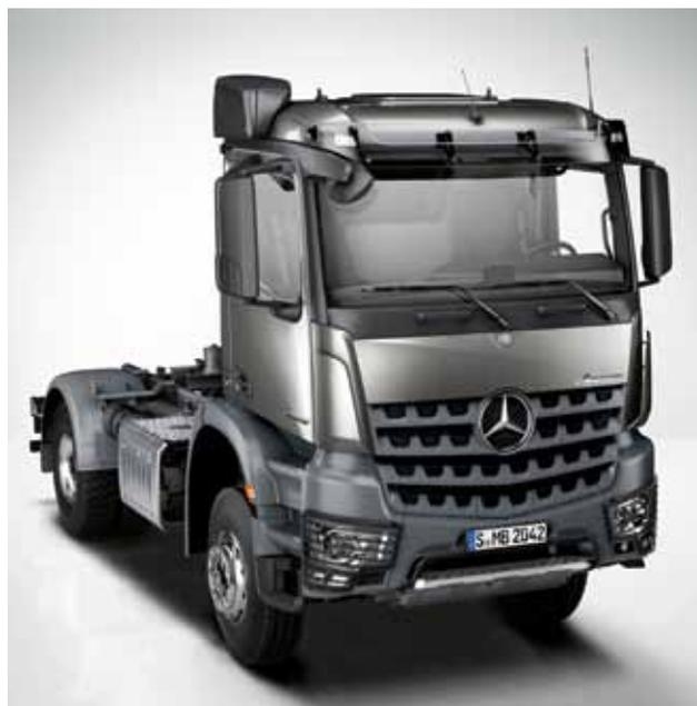
**Cabina S ClassicSpace<sup>1)</sup>.** A cabina com 2.300 mm de largura e 1.700 mm de comprimento com túnel do motor de 170 mm ou 320 mm de altura está totalmente concebida para as exigências do serviço da construção com um único tripulante, oferecendo uma boa visão geral.
