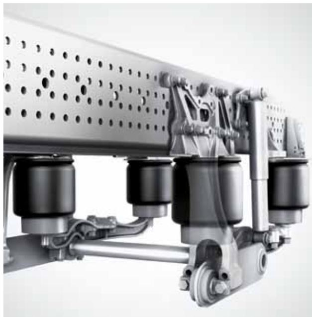
**Suspensão pneumática.** Para a utilização predominantemente em estrada o Arocs está equipado com um eixo traseiro hipóide com suspensão pneumática. Assim, o Arocs reúne vantagens como boa dinâmica de condução e elevado conforto de condução.
