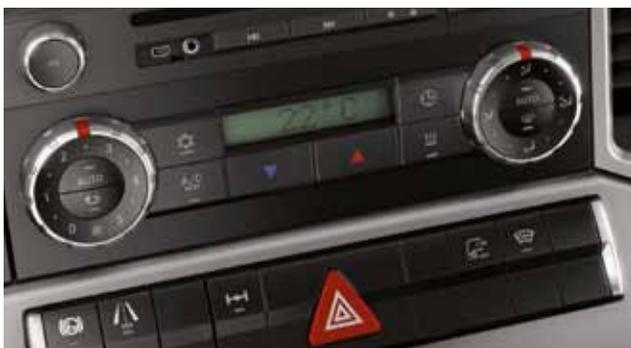
**Ar condicionado automático<sup>1)</sup>.** O sistema adapta automaticamente o caudal de ar, a distribuição de ar e a temperatura às condições ambientais e oferece outras funções de conforto.
