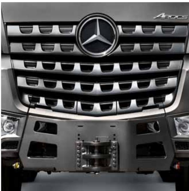
**Travessa para engate de cargas pesadas à frente.** Para serviços especialmente exigentes no transporte de cargas excepcionais, a travessa pode ser equipada para o engate de cargas pesadas à frente<sup>1)</sup>.
