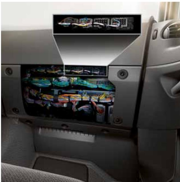
**Módulo especial parametrizável.** O módulo especial parametrizável<sup>1)</sup> (PSM) assegura um processamento perfeito da informação e a troca eficaz de informação entre o veículo e a carroçaria.
