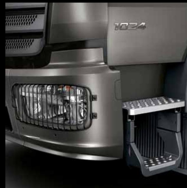
**Orientado para a utilização.** A elevada orientação para a utilização do novo Atego revela-se, por exemplo, no acesso móvel das variantes do Atego com tração integral. E pormenores como a grelha de proteção dos faróis<sup>1)</sup> que evitam danos e possibilitam simultaneamente uma limpeza rápida e simples dos faróis.
