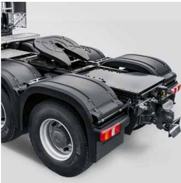
**Prato de engate (quinta roda) carga pesada<sup>1)</sup>.** Com este prato de engate (quinta roda), pode ser aproveitada a carga máxima no prato de engate (quinta roda) de um trator semirreboque de quatro eixos.
