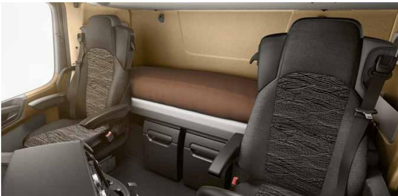
**Banco pneumático de conforto<sup>1)</sup>.** O banco pneumático pode ser ajustado individualmente, oferecendo assim as melhores condições ergonômicas e muito conforto, para o qual contribui também o aquecimento dos bancos integrado. O banco pneumático de conforto está equipado com regulação pneumática da altura, regulação da inclinação e profundidade da almofada, assim como apoio de cabeça integrado e cinto automático de três pontos integrado, regulável em altura.
