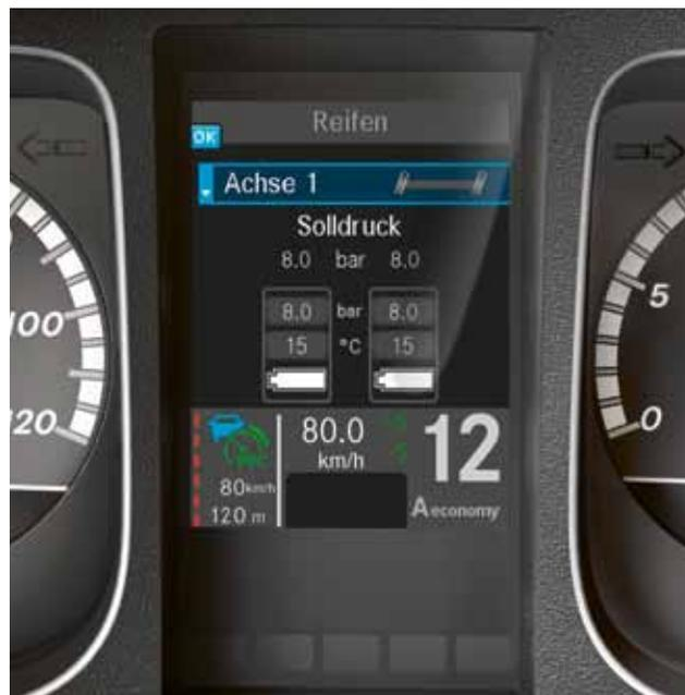
**Controlo da pressão dos pneus<sup>2) 4)</sup>.** O controlo da pressão dos pneus, sem fios, controla permanentemente a pressão do ar nos pneus e indica a pressão nominal necessária para a temperatura dos pneus no momento, em função da temperatura exterior.
