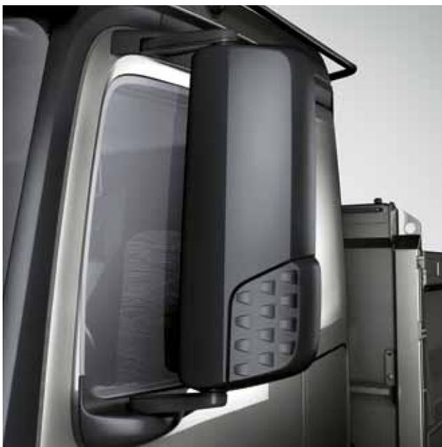
**Tampa do espelho exterior.** A tampa canelada do espelho exterior não se distingue apenas visualmente. Graças à sua superfície robusta, à prova de riscos, evita também danos no espelho, aumentando assim a segurança. No estaleiro a caminho dele.
