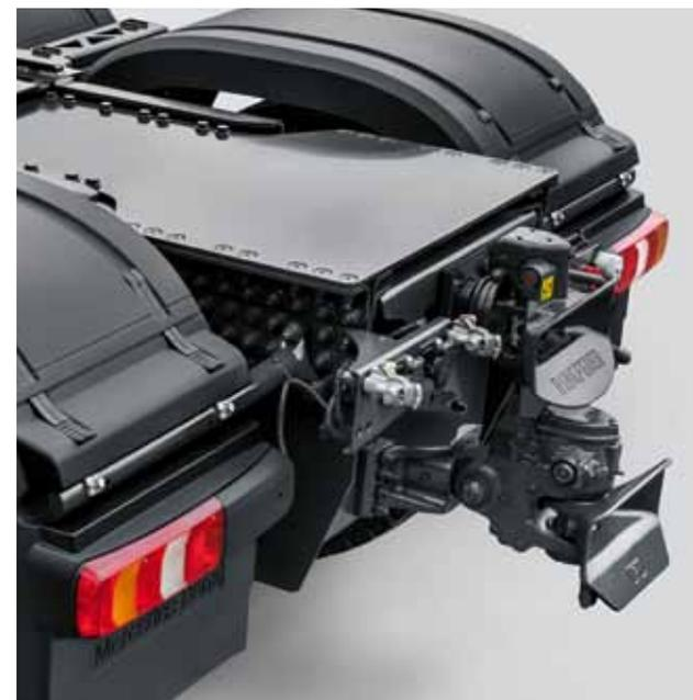
**Acoplamento para reboque de cargas pesadas<sup>1)</sup>.** O acoplamento de reboque de cargas pesadas do tipo 56 E está dimensionado para transportes até 250 t. Este pode ser montado na travessa de cargas pesadas em duas posições diferentes.
