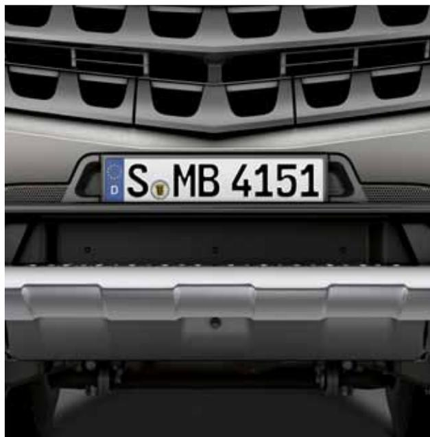
**Placa de proteção para motor e radiador.** Para proteção do radiador e do motor, os camiões basculantes com suspensão de aço dispõem de uma placa de proteção<sup>2)</sup>. Além disso, está disponível uma placa de proteção maciça para o depósito principal<sup>3)</sup>.
