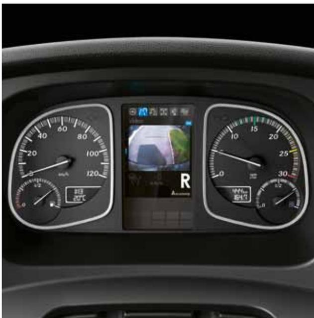
**Painel de instrumentos de 12,7 cm com função de vídeo<sup>1)</sup>.** Para um excelente conforto e segurança acrescida, este painel de instrumentos está preparado para a utilização de uma câmara traseira, com a qual a área atrás do veículo fica visível.
