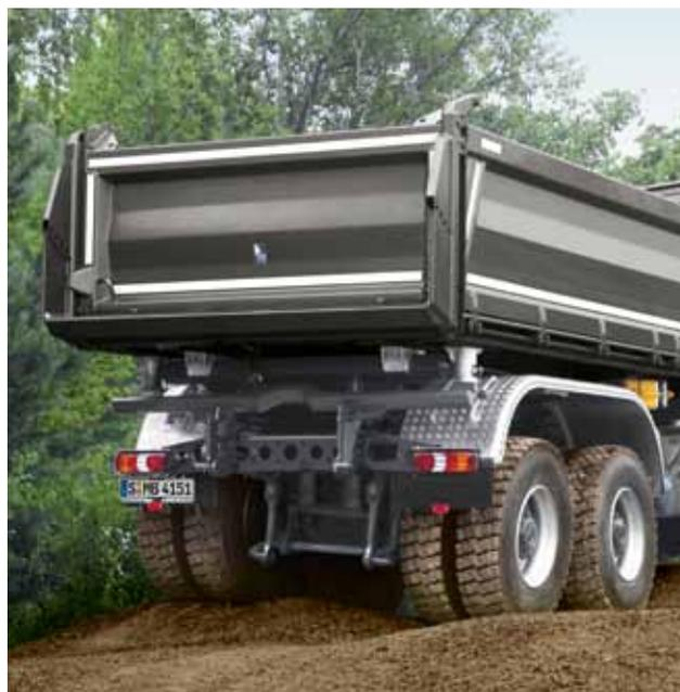
**Quadro com capacidade de torção.** Para o serviço na construção o Arocs está equipado com o quadro estreito de uma capacidade de torção peculiar. Desta forma, a enorme força chega ao solo sem perdas mesmo em terrenos acidentados.
