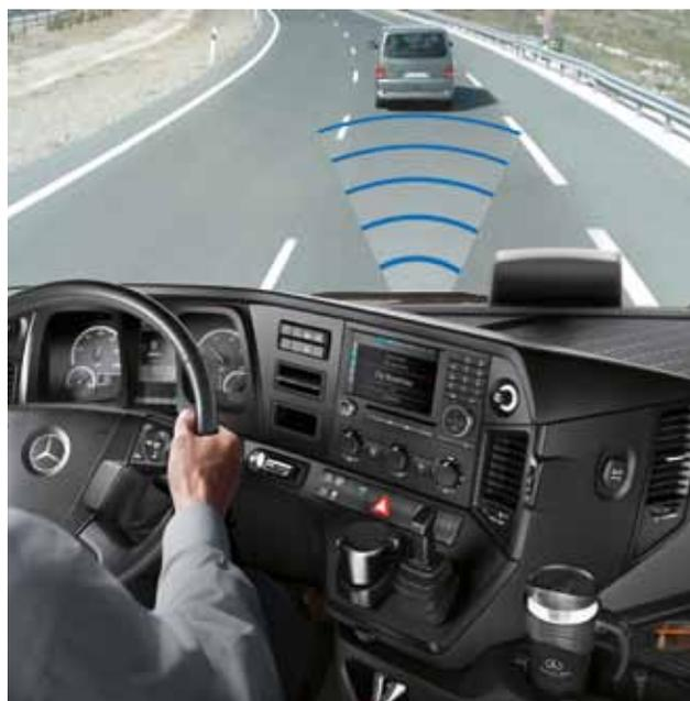
**Sistema de Regulação de Distância<sup>1) 2) 5)</sup>.** O sistema de segurança com função «stop-and-go» apoia o condutor em situações difíceis e pode minimizar o risco de colisões traseiras.
