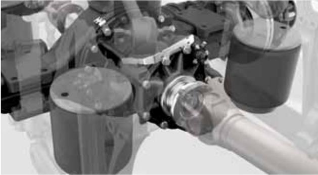
**Eixo traseiro, roda de coroa 440, hipoide, 13,0 t.** O eixo traseiro é um eixo moldado em chapa de aço, otimizado em relação ao peso, com coroa de 440 mm. É montado em veículos de 3 eixos com um peso total do veículo com reboque até 80 t e a partir de 2.200 Nm.
