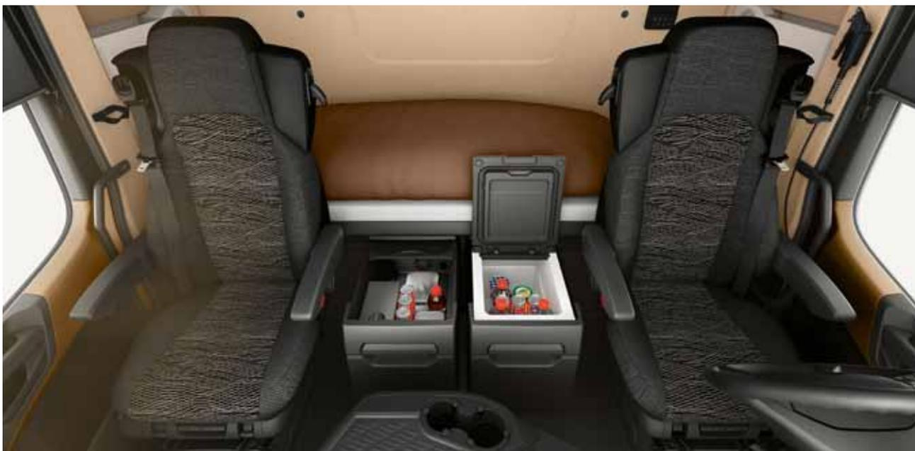
**Conforto de habitabilidade na cabina L BigSpace.** A cabina L BigSpace, com 2.500 mm de largura para serviços orientados para a estrada e com dormidas frequentes, possui uma cama conforto com 2.000 mm de comprimento e 750 mm de largura. Os compartimentos de arrumação em baixo são acessíveis por dentro e por fora e oferecem muito espaço, mesmo para objetos volumosos. Para uma melhor divisão estão disponíveis como opção dois porta-objetos deslocáveis e amovíveis.
