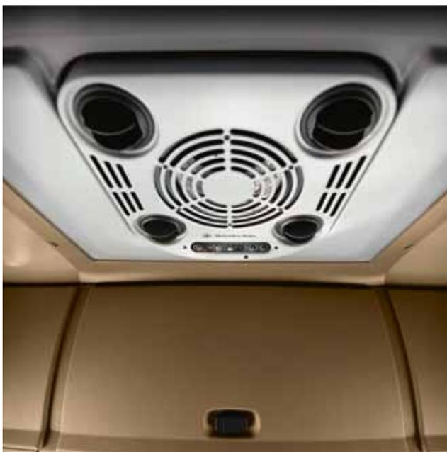
**Ar condicionado de parque no tejadilho.** O ar condicionado de parque no tejadilho permite uma potência de arrefecimento até 850 W e proporciona um ambiente agradável graças à desumidificação adicional do ar.
