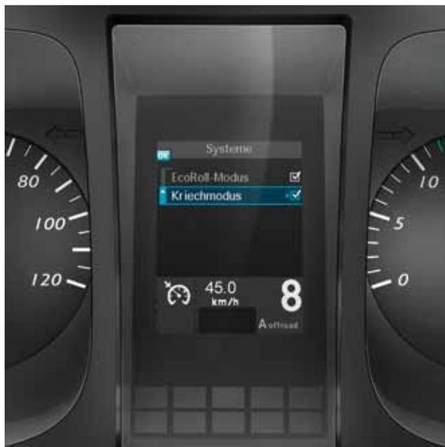
**Indicação da mudança.** No painel de instrumentos são sempre indicados o modo de transmissão atual e a velocidade engrenada da caixa automatizada Mercedes PowerShift 3. Isto é particularmente vantajoso quando influencia manualmente a seleção da velocidade.
