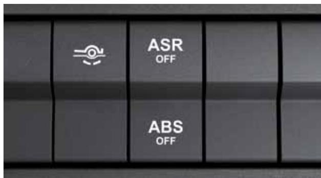
**ABS, desativável<sup>2)</sup>.** O sistema antibloqueio desativável aumenta a segurança nas operações em terrenos difíceis – devido ao bloqueio das rodas gera-se um calço a partir da substância macia do solo, que contribui para uma distância de travagem mais curta.
