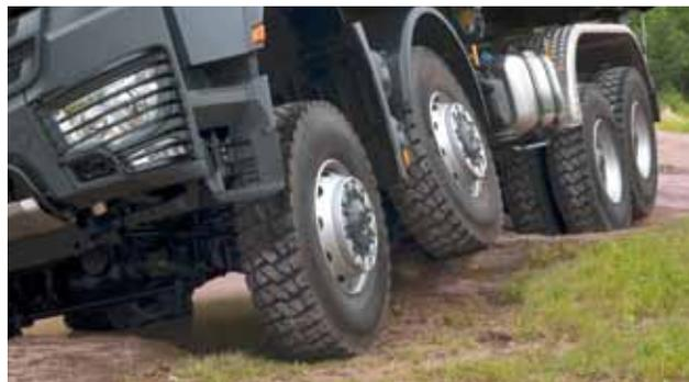
**Compensação da carga sobre os eixos.** A distribuição de carga pelos eixos dianteiros evita danos provenientes de sobrecarga nos veículos 8x6 e 8x8.
