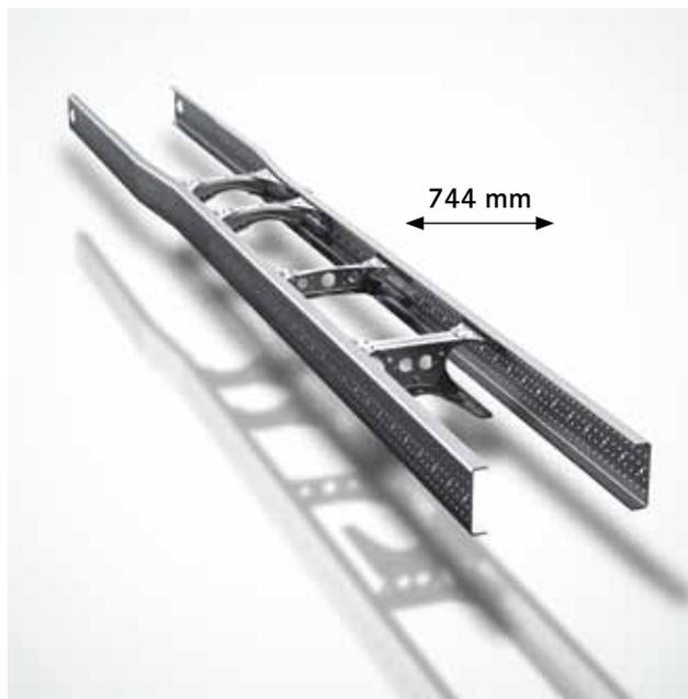
**O chassis certo para cada serviço.** O serviço na construção e na estrada coloca requisitos diferentes ao chassis. Por este motivo, desenvolvemos dois para o Aroc. Um, mais estreito, com 744 mm de largura que convence mesmo em condições de terreno extremas pela elevada capacidade de torção e pela estabilidade. E um segundo, mais largo, com 834 mm de largura que pode explorar todas as suas vantagens na estrada, mas que convence ao mesmo tempo em operações leves fora de estrada.
