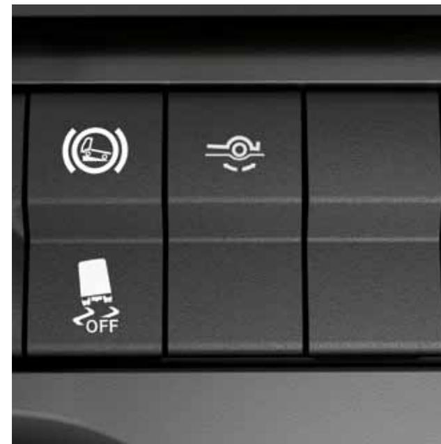
**Modo de balanceio.** O modo de balanceio é acionado por um botão. Ao pisar e ao soltar rápida e alternadamente o pedal do acelerador, o veículo começa a balançar. Deste modo um veículo que tenha ficado atolado num terreno pantanoso consegue sair pelos seus próprios meios.
