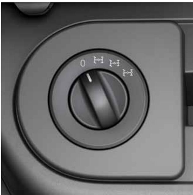
**Bloqueios longitudinais e transversais.** Estão disponíveis, consoante o modelo de veículo, diversos bloqueios de diferencial. Estes são ativados através de um interruptor na sequência de bloqueio longitudinal, bloqueio dos eixos de tração traseiros e – quando instalados – bloqueio dos eixos de tração dianteiros.
