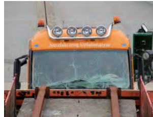
Comprobación exhaustiva: portafaros de techo en la prueba de choque.
