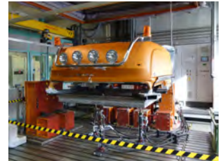
Banco de pruebas con hidropulsadores para simular baches y carreteras en mal estado.
