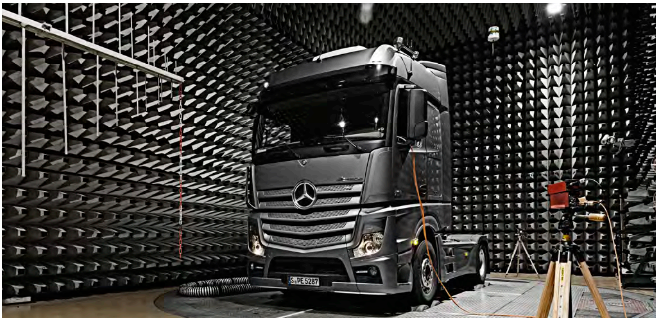
Comprobación EMV en una nave especialmente apantallada contra interferencias electromagnéticas ajenas.
