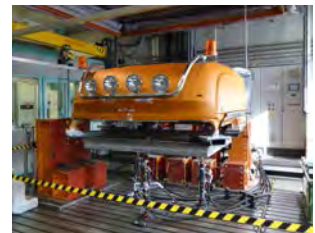
Banc d'essai à hydropulseur servant à simuler des nids-de-poule et des routes dégradées.
