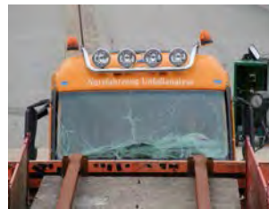
Déformation et rupture contrôlées : le support pour lampes de toit à l'épreuve du crash test.
